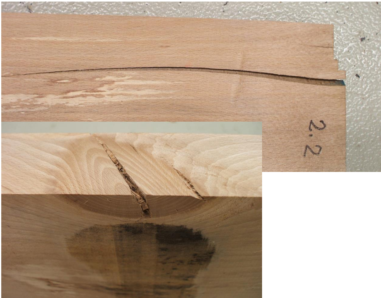
Bilder 9 und 10: Eis-Buche, Probenabschnitt 2.2, Riss und Kantenast
